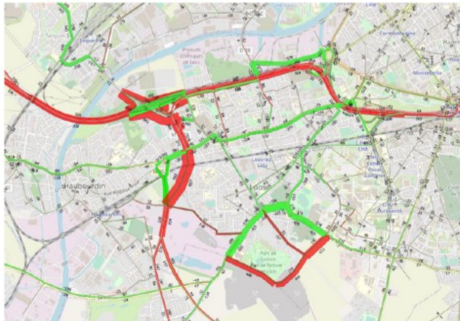
Figure 15 - Différence en volumes avec le scénario de référence après mise en service des TF1, TF2 et TF3 (HPM)
